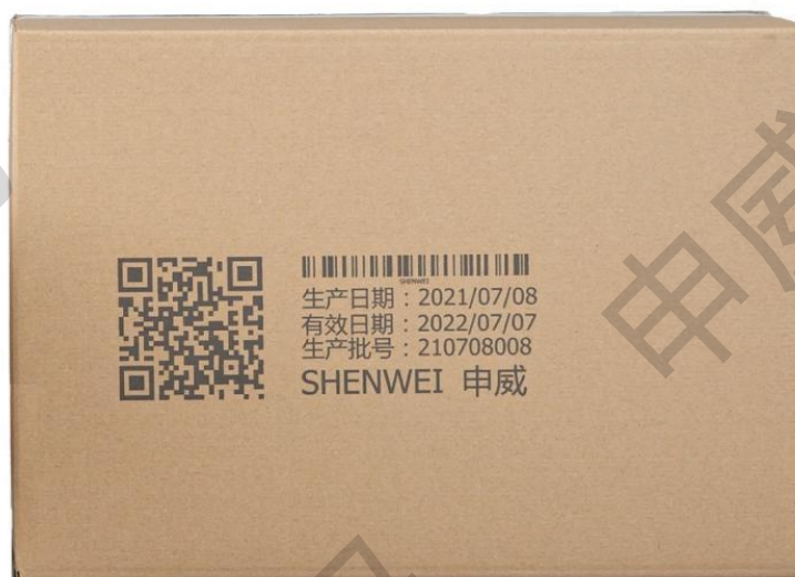
纸箱多行信息喷码 (字高 96mm)
