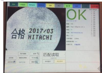
视觉软件对采集信息进行比对后得出正确结果，显示“OK”
